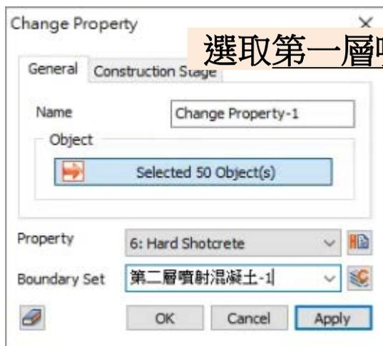
選取第一層噴射混凝土-1網格集
