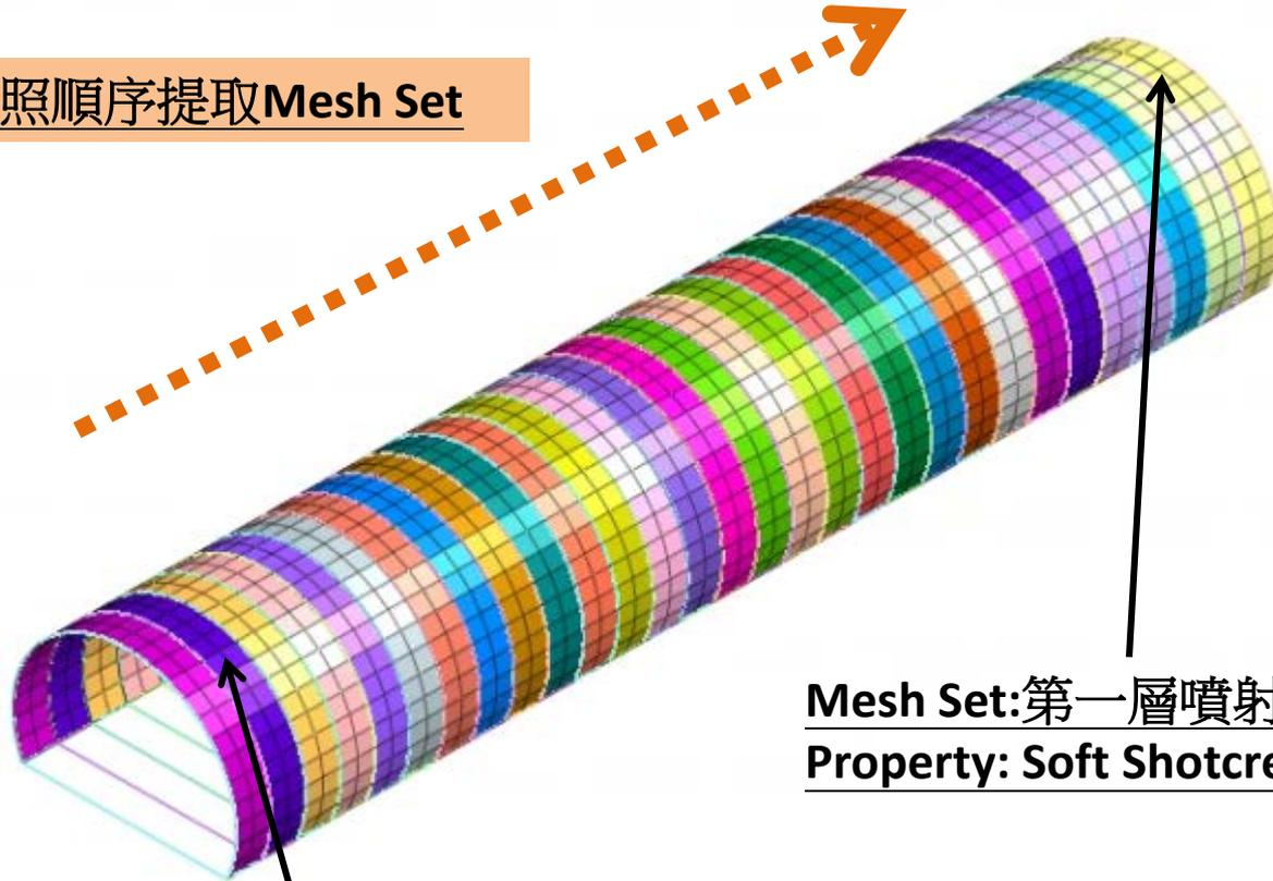
Mesh Set:第一層噴射混凝土-30
